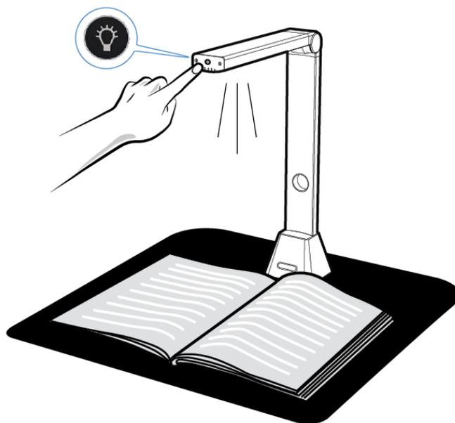
**注意：**在拍摄仪硬件折叠（关闭）时，请确保 LED 灯号是否已被关闭，否则此可能会产生机台过热现象。
